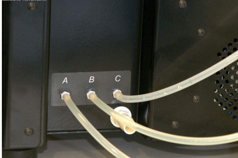
Şekil 4-4: Cihazın sağ tarafında bulunan atık portları
