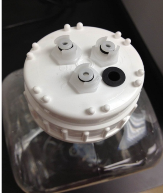
Şekil 7-1: Reaktif Hattı Bağlantılarını Yıkama Şişesine yerleştirin
