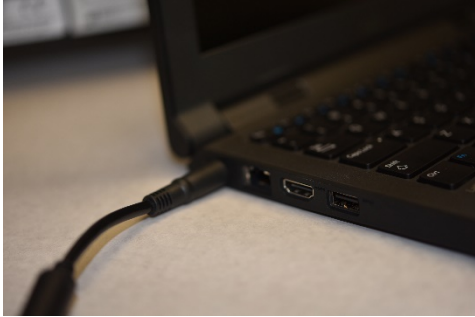
Şekil 3-2: Güç kaynağı kablosu
