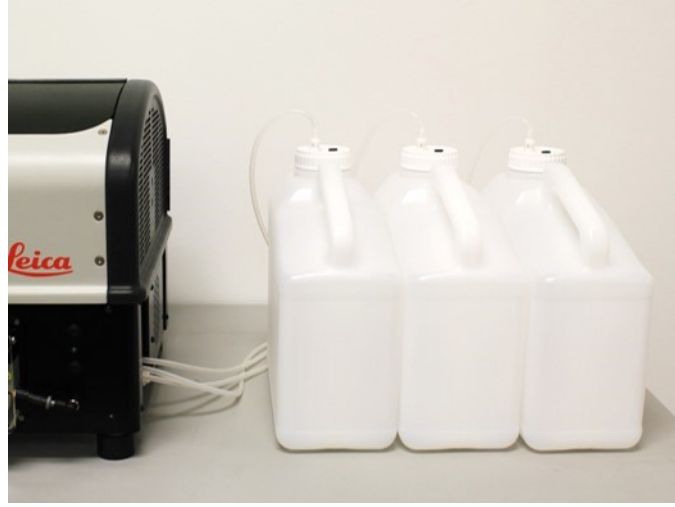
Şekil 3-14: Atık Şişesi Konumlandırma–Yüzey Seviyesi
