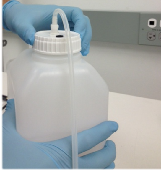
Şekil 3-12: Atık Kapaklarını Atık Şişelerine Takın
