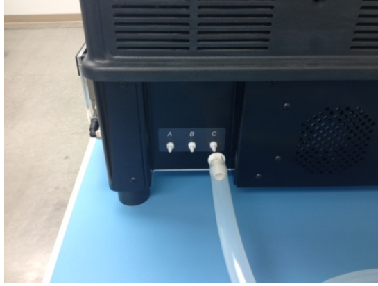
Şekil 3-16: Acil Atık Tüpünü, Acil Atık Portuna Bağlama
