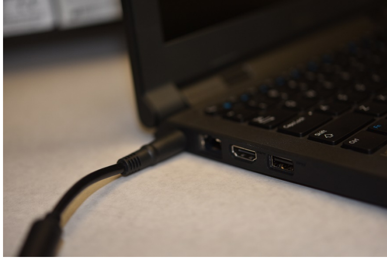
Şekil 8-2: Netbook ve Cihaz arasındaki USB Bağlantısı
