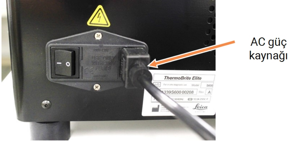
Şekil 3-1: Cihazın arkasında bulunan güç portu
