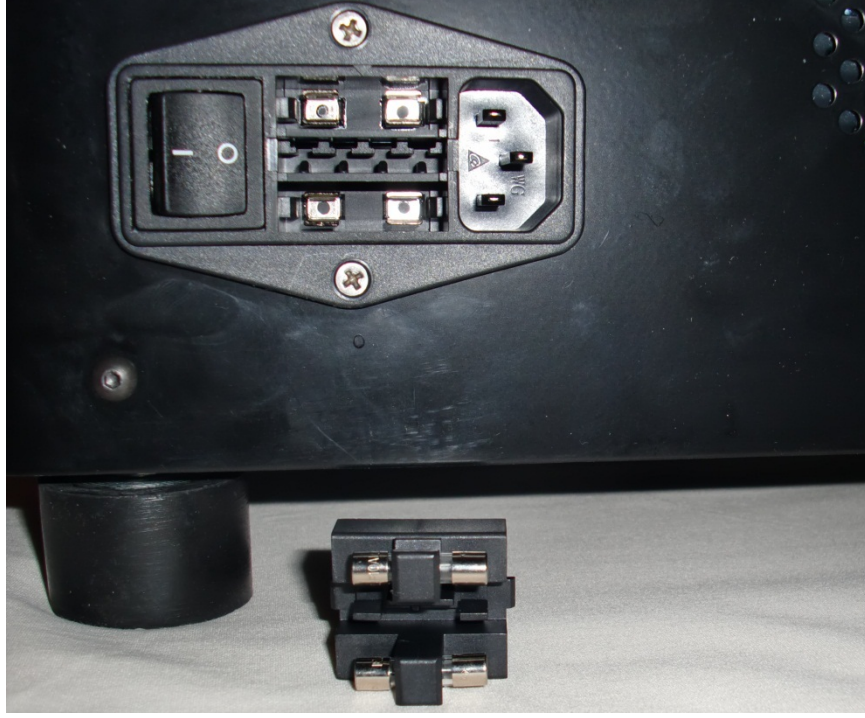
Şekil 7-15: Güç Anahtarı–Sigortayı Değişirme
