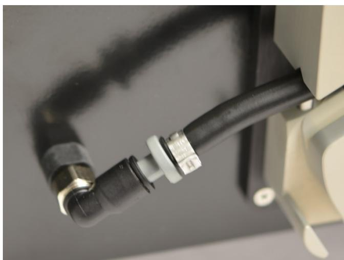
Figura 7-10: Remoção do plugue da porta de saída
