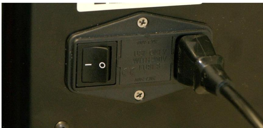
Figura 7-13: Interruptor de alimentação – Caixa de fusíveis
