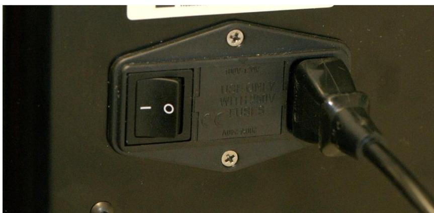
Figura 7-13: Interruptor de alimentación: Caja de fusibles
