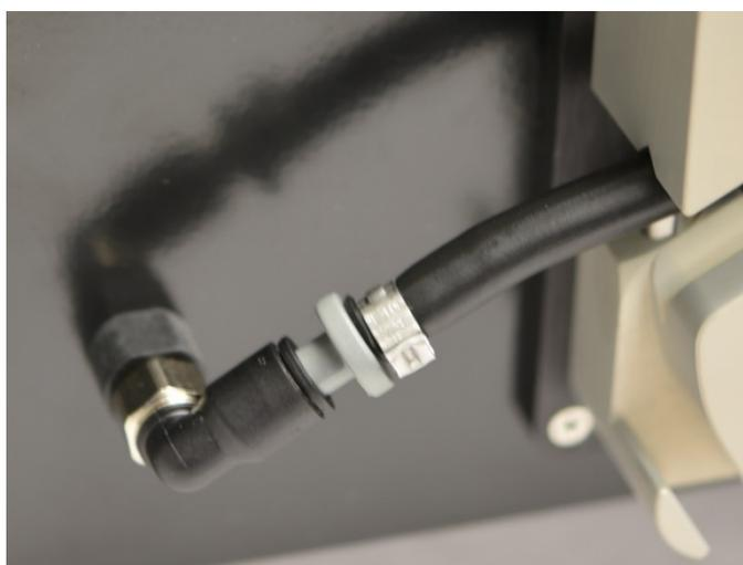
Figura 7-10: Retire el enchufe del puerto de salida
