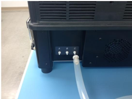
Figura 3-16: Conecte el tubo de residuos de emergencia al puerto de residuos de emergencia.
