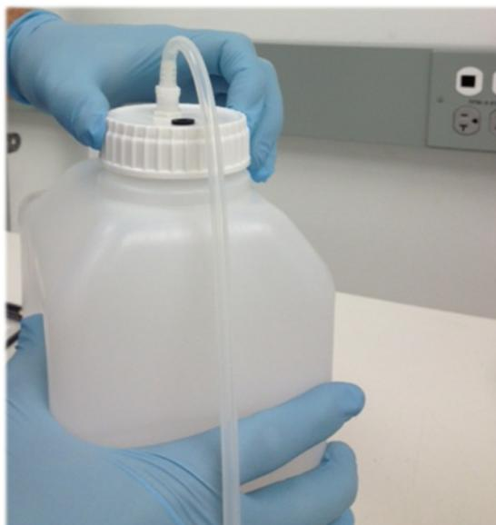
Figura 3-12: Enrosque los tapones de residuos en las botellas de residuos
