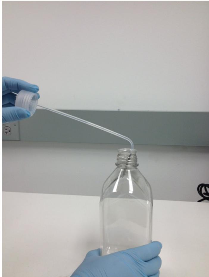
Figura 5-2: Retirada de tapones y filtros de botellas de reactivos
