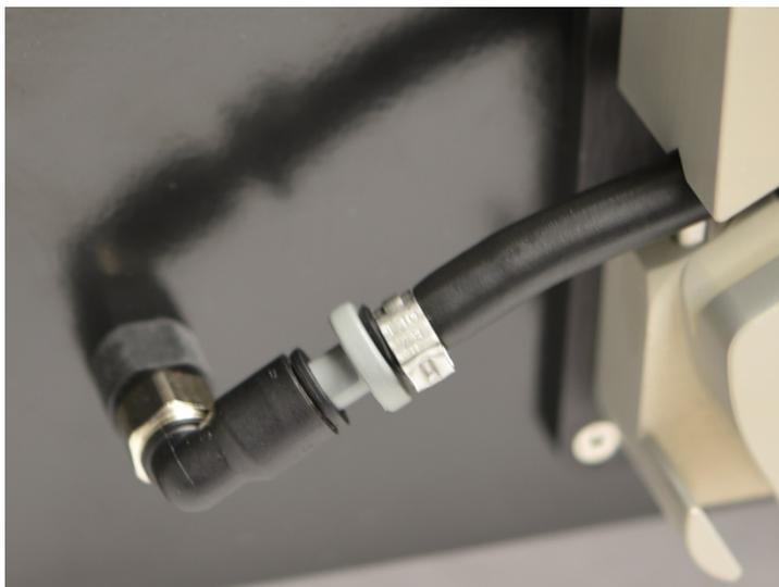
Figura 7-11: Inserte el enchufe en el puerto de salida y entrada
