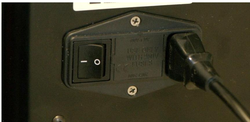
Figura 7-13: Interruptor de alimentação – Caixa do fusível
