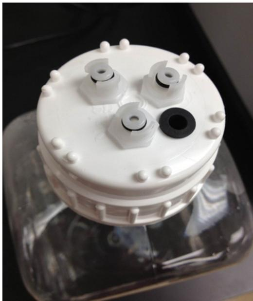
Figura 7-1: Inserir os encaixes da linha de reagente na garrafa de lavagem
