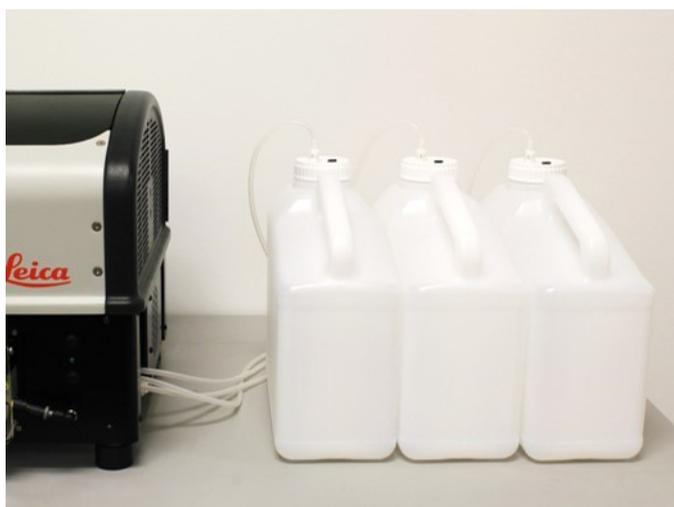
Figura 3-14: Posicionamento da garrafa de resíduos – Nível da superfície
