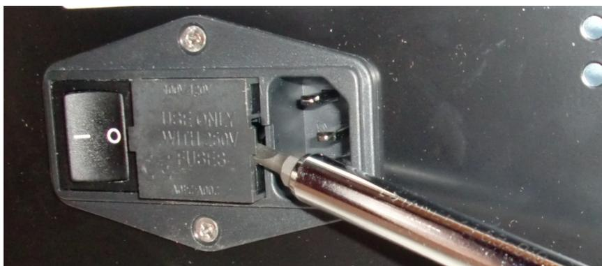
Figura 7-14: Interruptor de alimentação – Aceda ao suporte de fusíveis
