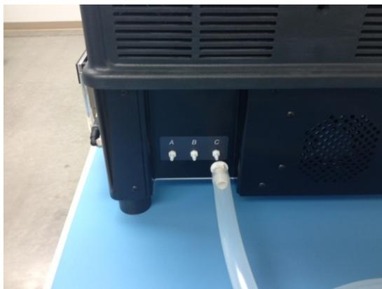
Figura 3-16: Ligue o tubo de resíduos de emergência à porta de resíduos de emergência.
