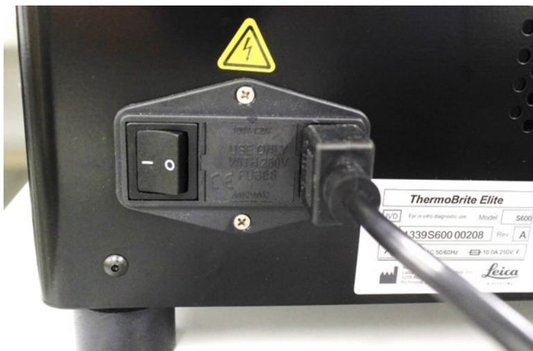
Figura 4-10: Interruptor de alimentação – inclui a caixa de fusíveis
