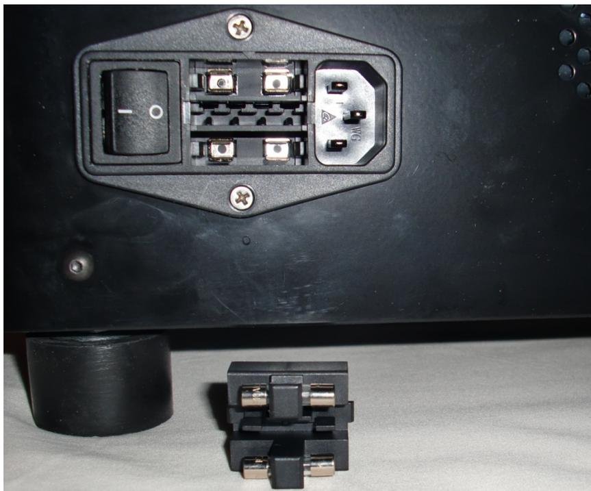
Figura 7-15: Interruttore di alimentazione - Sostituzione fusibili
