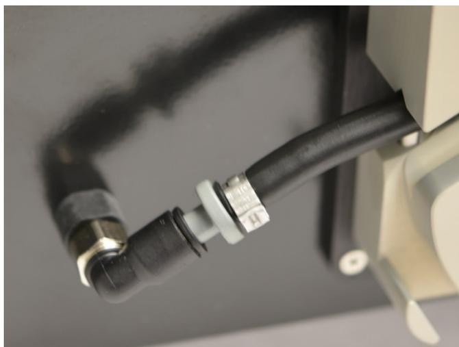
Figura 7-10: Rimozione del connettore dalla porta di uscita
