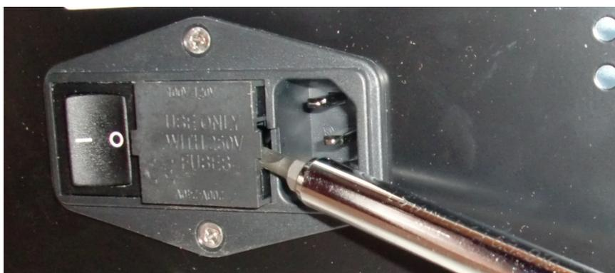
Figura 7-14: Interruttore di alimentazione - Accesso al portafusibili
