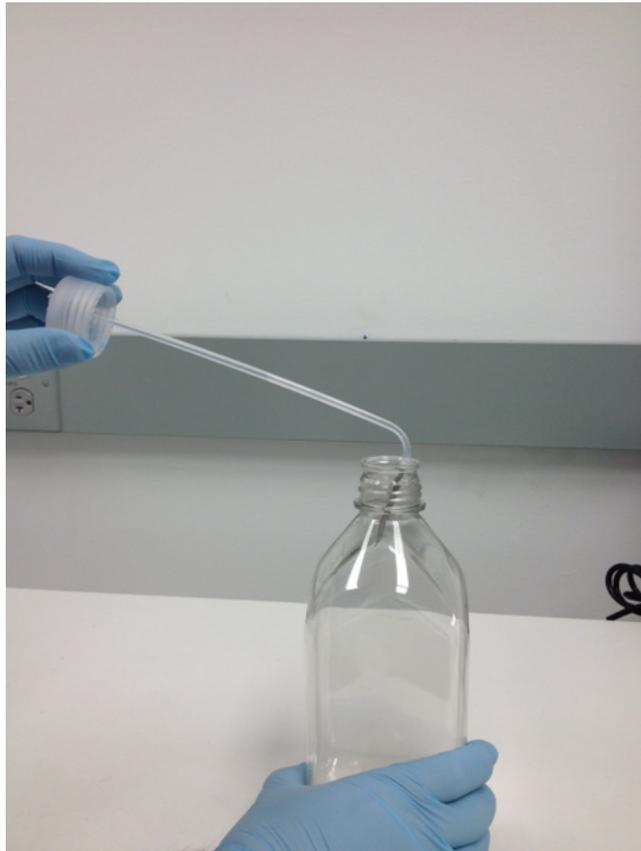
Figura 5-2: Rimozione dei tappi e dei filtri dei flaconi di reagente
