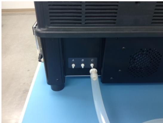
Figura 3-16: Collegare il tubo di scarico di emergenza alla porta di scarico di emergenza.
