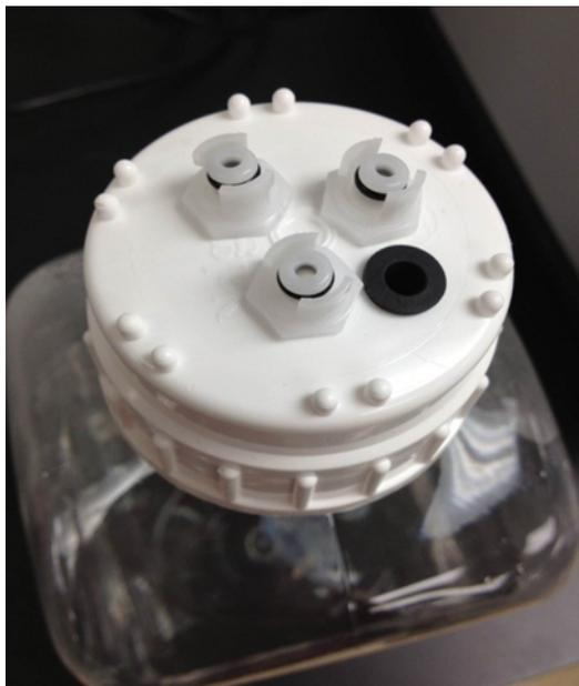
Figura 7-1: Inserire i raccordi della linea del reagente sul flacone di lavaggio
