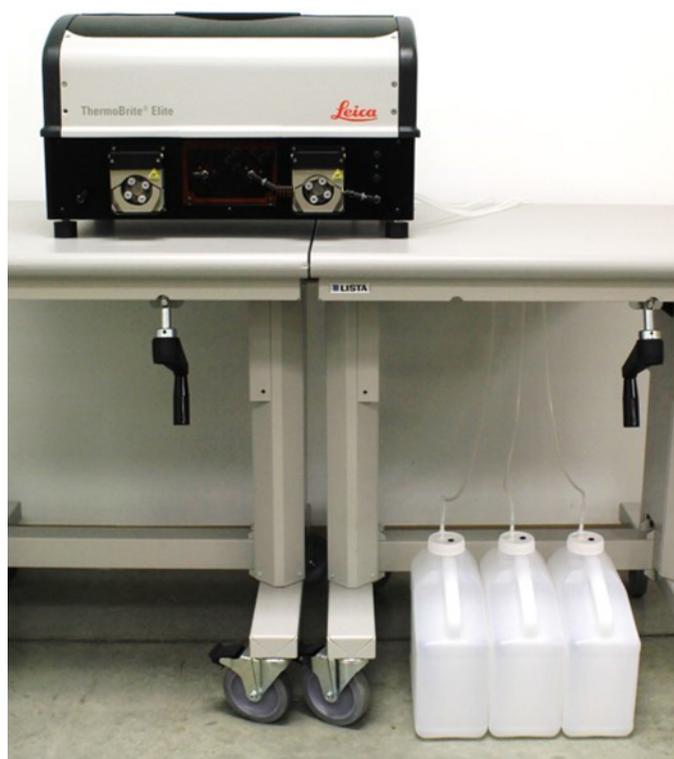
Figura 3-15: Posizionamento del flacone scarto–Livello terra
