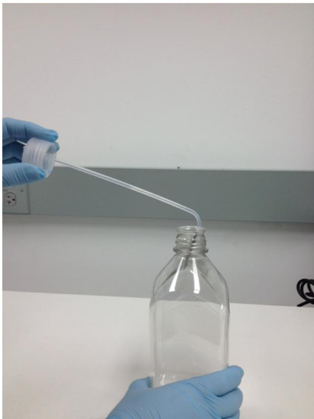
Abbildung 5-2: Reagenzflaschenverschlüsse und -filter entfernen
