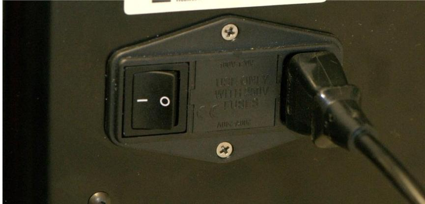
Abbildung 7-13: Netzschalter – Sicherungsfach
