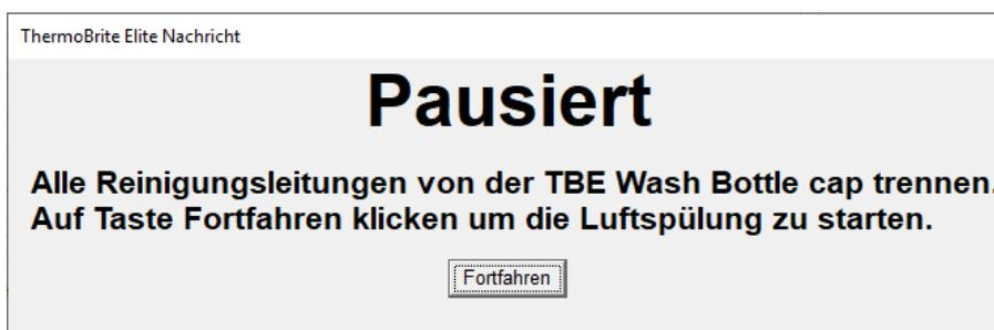
Abbildung 7-5: Pause-Meldung – Reagenzleitungen entfernen
