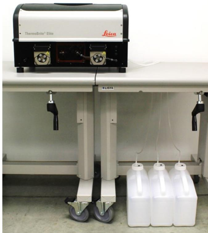
Abbildung 3-15: Position der Abwasserflaschen – Bodenhöhe
