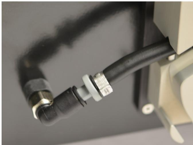
Abbildung 7-10: Stopfen vom Auslassport entfernen
