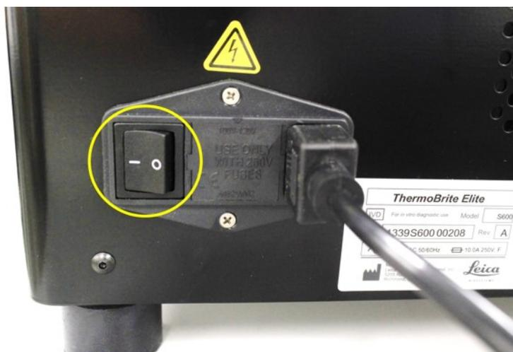
Abbildung 3-5: Netzschalter
