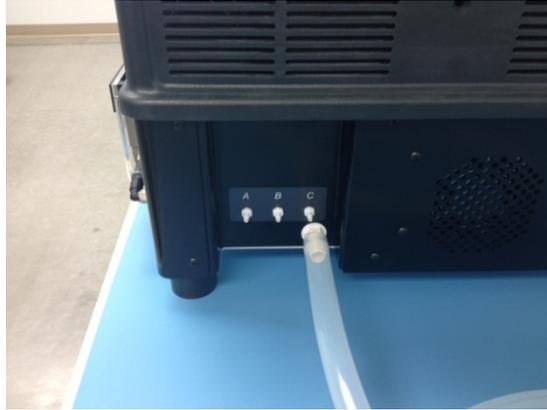
Abbildung 3-16: Notabwasserleitung am Notabwasserport anschließen
