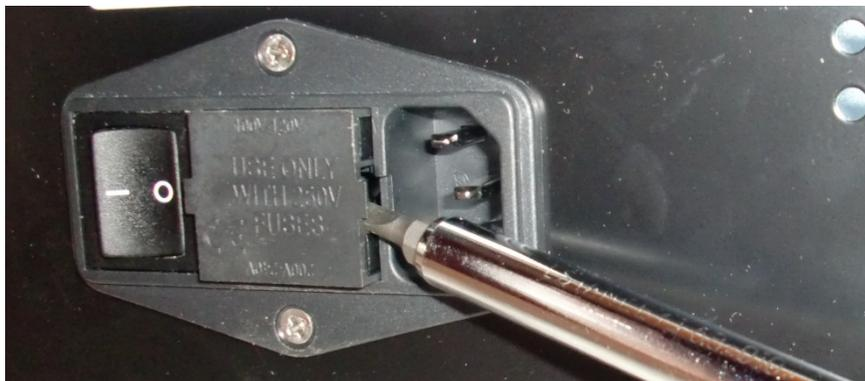
Abbildung 7-14: Netzschalter – Sicherungshalter öffnen
