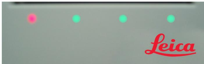
Slika 2-14: Boja LED svetla tacne sa reagensima (crvena, zelena) na BOND-MAX instrumentu
