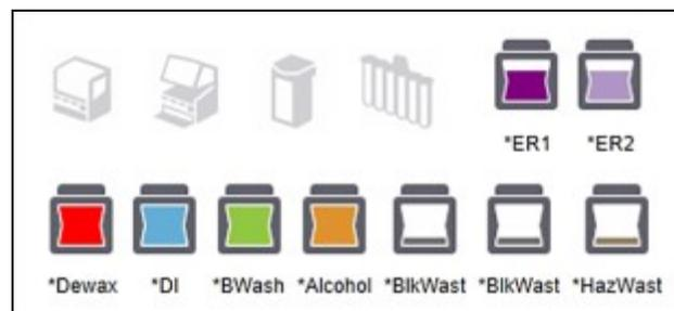
Slika 5-9: Kontejneri za velike količine reagenasa (BOND-III konfiguracija)
