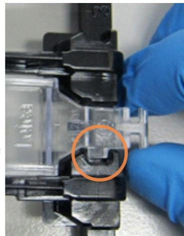
Postoji dva dizajna Covertile poklopaca – mogu se koristiti naizmenično. Novi dizajn obuhvata karakteristike (reč **Leica**, malu kružnu oznaku i ispupčenje na gornjoj levoj ivici) koje olakšavaju uočavanje nepravilno postavljenog Covertile poklopca na slajdu.
