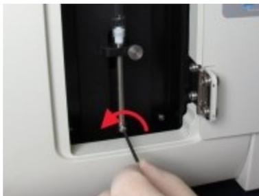
Slika 12-19: Odvrnite vijak za blokadu klipa šestougaonim ključem
