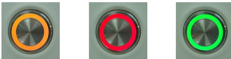
Slika 2-13: Boja LED svetla nosača slajdova (narandžasta, crvena, zelena) na BOND-MAX instrumentu
