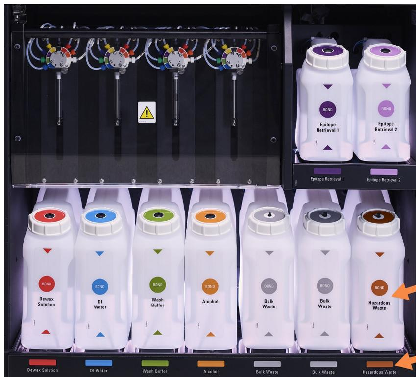
Proverite da li se boja nalepnice i štampani opis na svakom kontejneru za veliku količinu reagenasa slažu sa nalepnicom na odeljku instrumenta odmah ispod kontejnera.
