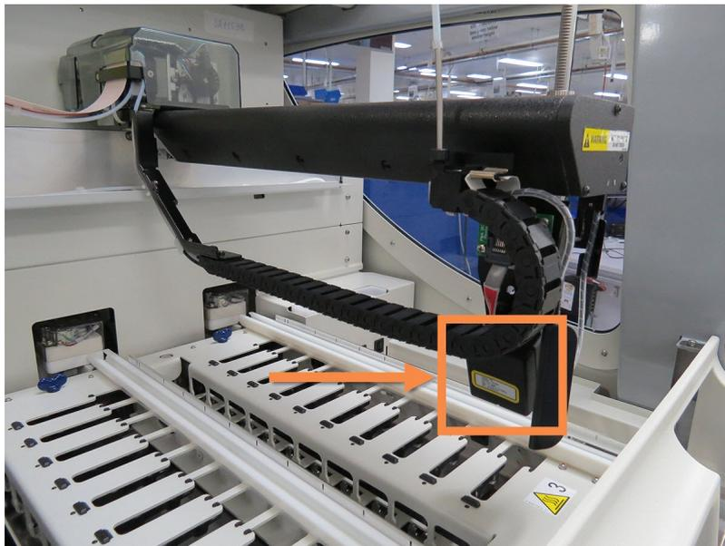
Slika 2-7: Fotografija glavnog robota sa ID skenerom naznačenim strelicom
