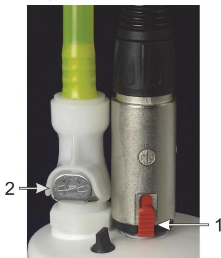
Figure 126 : Connexions du récipient à déchets externe : raccord de liquide à gauche et capteur de niveau du liquide à droite
