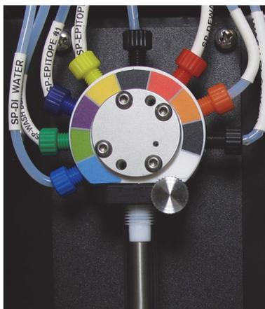
Figure 24 : BOND-MAX Seringue à 9 ports
