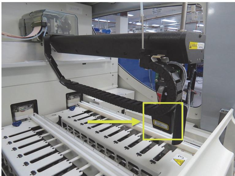
Figure 7 : Photo du robot principal avec l'imageur d'ID indiqué par la flèche
