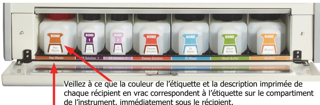
Figure 17 : Réactifs en vrac BOND-MAX en position
