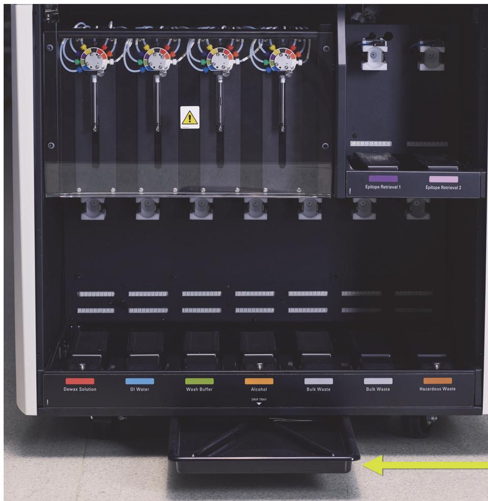
Figure 138 : Le plateau antigoutte de l'instrument BOND-III
