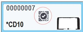
Lame imagée et identifiée manuellement – notez le symbole (cerclé de rouge) sur la lame (voir [5.1.5.2 Identification manuelle des lames à bord](#))
