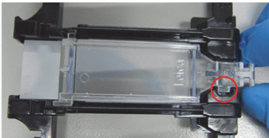
Figure 44 : Mise en place d'un Covertile sur une lame
