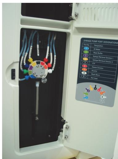
Figure 6 : Seringue derrière la porte battante
