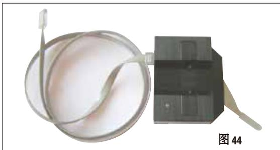
选配的测量仪器，用来显示刀片的纵向偏离 (以  $\mu\text{m}$  为单位)，以及显示用于减小刀片纵向偏离的螺丝的旋转方向。可使用刀架上的调整螺丝进行调整。
