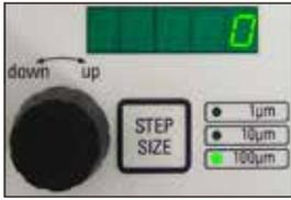
用于设置纵向移动样品座的旋钮 2 可用来微调刀片至样品的接近程度，以及所需切片厚度。可按下 **STEP SIZE** (步长) 键选择步长 1、10 或 100  $\mu\text{m}$ 。
