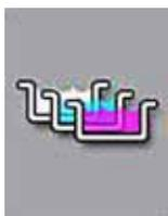
按下相鄰的功能表按鈕，將顯示儀器中的容器區 (→「圖69」)。此顯示畫面將顯示儀器中試劑站點、沖洗水站以及載入和卸載站點的目前佈局。
