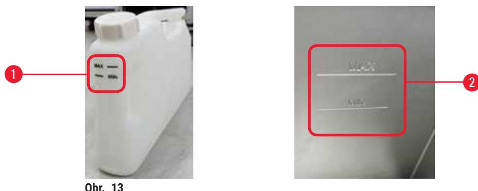
Retorty je možné naplniť dostatočným množstvom činidla pre dva košíky na kazety. Značky na reagenčných fl'ašiach (→ Obr. 13-1) a v parafínovej vani (→ Obr. 13-2) pomôžu určiť, či je dostať činidla na naplnenie retort na požadovanú úroveň. Vždy udržujte objemy činidla a parafínu výrazne nad minimálnou (MIN) hladinou, ale pod maximálnou (MAX) hladinou. Hladiny činidiel pod minimálnou úrovňou spôsobia, že protokoly budú zlyhajú, alebo sa použije suboptimálna sekvencia činidiel.
