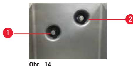
Každá retorta má dva snímače hladiny kvapaliny na monitorovanie hladiny kvapaliny. Spodný snímač (→ Obr. 14-1) monitoruje hladinu dvoch košíkov. Vrchný snímač (→ Obr. 14-2) sa zapne, ak sa do retorty dostane viac tekutiny, ako je maximálny objem. Slúži ako bezpečnostná funkcia.
