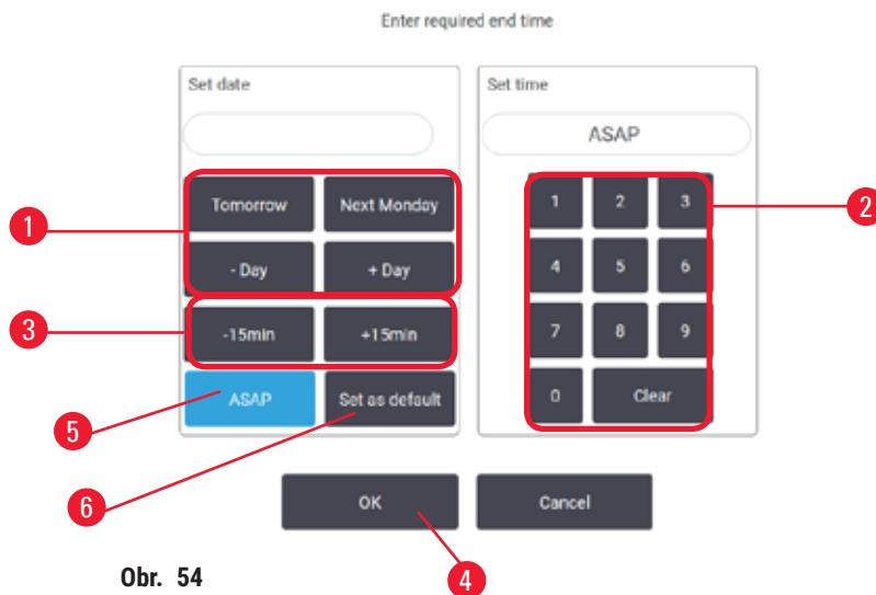
Môžete zmeniť čas ukončenia aktuálne zvoleného chodu v dialógovom okne **Enter required end time** (zadať požadovaný čas ukončenia) (→ Obr. 54), otvorenom z dialógového okna **Time to edit** (čas na úpravu) ťuknutím na tlačidlo **Edit end time** (upraviť čas ukončenia) (→ Obr. 53-5).
