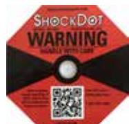
U sistemu „Shockwatch”, tačka na preciznoj staklenoj cev prikazuje crvenom bojom potrese ili udare koji su iznad dozvoljenog intenziteta. Prekoračenje definisanog ubrzanja (g vrednosti) uzrokuje da indikatorska cev promeni boju.
