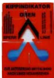
Indikator „Tip-n-Tell“ za nadgledanje da li je isporuka preneta i skladištena u uspravnom položaju, u skladu sa zahtevima. Sa nagibom od 60° ili više, pesak od plavog kvarca ulazi u indikator u obliku strelice i tu se trajno zadržava. Nepravilno rukovanje isporukom se odmah otkriva i može da se dokaže sa sigurnošću.
