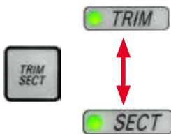
要在切片模式和修片模式之间切换，可按下 **TRIM/SECT** (修片/切片) 按钮。每次按下按钮后，显示屏将在 **SECT** (切片) 和 **TRIM** (修片) 之间切换。**SECT** (切片) 显示屏显示 0.25 到 50.0  $\mu\text{m}$  之间的切片厚度，**TRIM** (修片) 显示屏显示 1.0 到 300  $\mu\text{m}$  之间的修片厚度。
