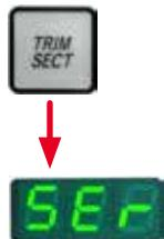
装置の延べストローク回数が約 200 万回を超えると、TRIM/SECT ボタンを押す（トリミングモードとセクショニングモードを切り替える）たびに 3 行ディスプレイにコード「SER」が約 3 秒間表示されます。
