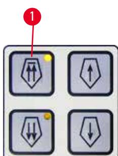
電動粗送りは、試料をナイフに高速で近づけ、あるいは遠ざけるのに使用します。
