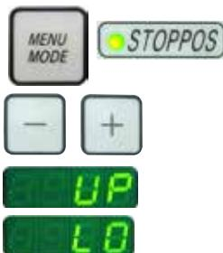
試料ヘッドの下部戻りポイントは停止位置として設定できます。
