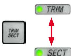
セクショニングモードとトリミングモードを切り替えるには、セパレート式コントロールパネルの TRIM/SECT ボタンを押します。ボタンを押すごとに、SECT と TRIM が交互に切り替わります。
