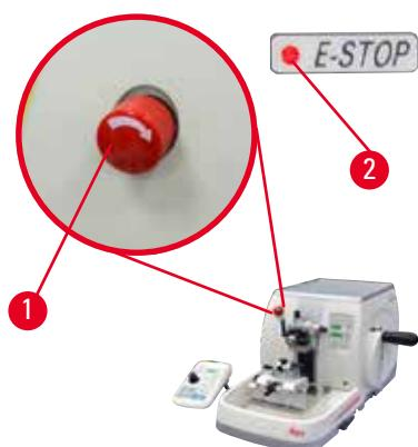
緊急停止機能をオンにするには、ミクロトーム前面の左上にある赤の緊急停止スイッチ(→「図 1-1」)を操作します。緊急停止スイッチを押すと、ただちにセクショニングモーターが停止します。本体コミュニケーションディスプレイ上にある E-STOP フィールドの赤の LED(→「図 1-2」)が点灯し、緊急停止機能が作動中であることを示します。
