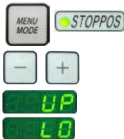
El punto de retorno inferior del cabezal de la muestra se puede ajustar como posición de parada.
