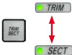
要在切片模式和修片模式之间切换，可按下 **TRIM/SECT**(修片/切片)按钮。每次按下按钮后，显示屏将在 **SECT**(切片)和 **TRIM**(修片)之间切换。**SECT**(切片)显示屏显示 0.50 到 100.0  $\mu\text{m}$  之间的切片厚度，**TRIM**(修片)显示屏显示 1.0 到 600  $\mu\text{m}$  之间的修片厚度。
