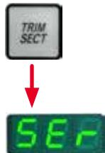
После выполнения прибором прим. 2 миллионов ходов при нажатии кнопки **TRIM/SECT** (переключение между режимами надрезания и выполнения срезов) на трехзначном индикаторе всегда появляется индикация **SER** (на 3 секунды).
