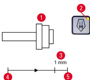
Во время надрезания и выполнения срезов, когда до достижения передней границы подачи остается расстояние около 1 мм (→ "Рис. 23-3"), система выдает соответствующее предупреждение в виде оптического и акустического сигналов. Желтый светодиод (→ "Рис. 23-2") в кнопке грубой подачи горит непрерывно с момента достижения остаточного расстояния подачи.
