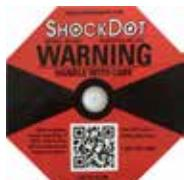
在 Shockwatch 系統中，衝擊點以紅色表示超過指定強度的撞擊或衝擊。超過指定的加速度 (g 數值)，就會導致指示管改變顏色。
