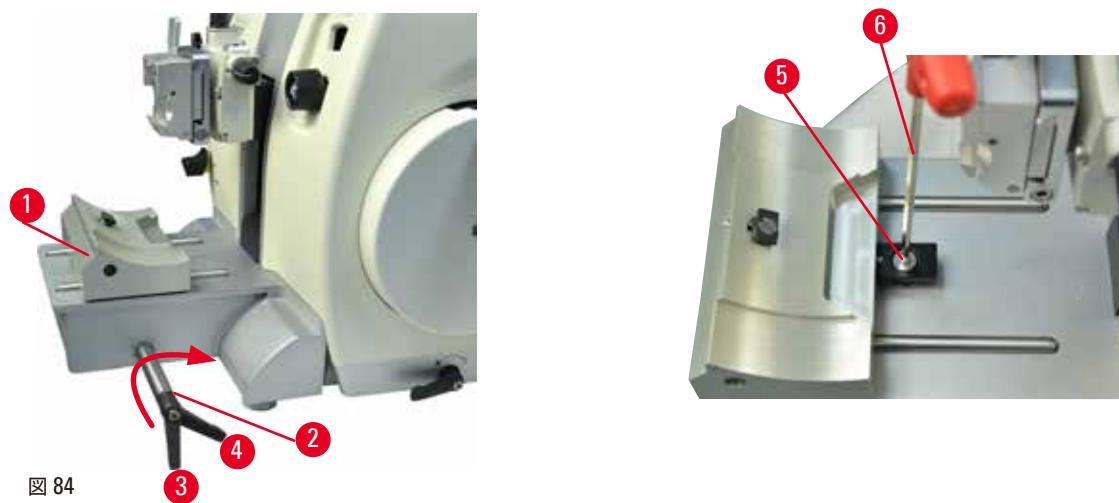
クランプ距離を偏心ボルトから 270°に設定するには、以下の手順を実行します。
