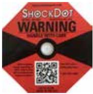
在 Shockwatch 系统中有个测震点，可以红色色调图显示超过指定强度的冲击或撞击。超过规定的加速( $g$ 值)将导致指示管改变颜色。
