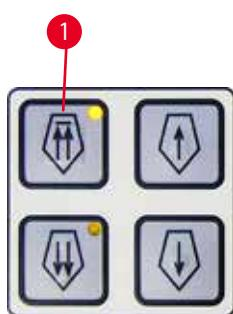
电动粗进用于快速将样品移向和远离切片刀。
