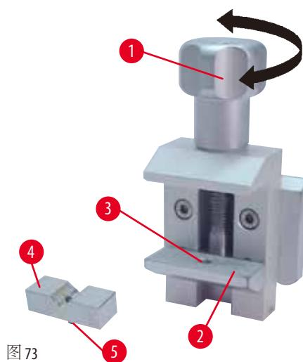
V型样品夹(→"图 73-4")装在标准样品夹下方活动颚板上的小孔中。这样标准样品夹就能够夹紧圆形样品。
