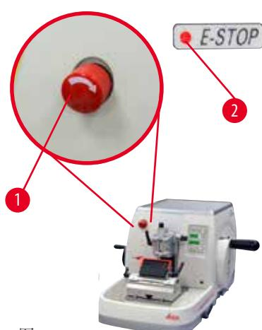
紧急停止功能通过切片机前侧左上方的红色紧急停止开关([→ "图 1-1"](#))启动。按下紧急停止开关后，切片电机立即停止。仪器控制面板中 E-STOP(紧急停止)区的红色 LED ([→ "图 1-2"](#)) 亮起，指示已启动紧急停止功能。
