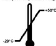
Показывает допустимый диапазон температур при транспортировке оборудования в упаковке.
