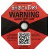
Встроенная в индикатор Shockwatch ударная точка указывает на удары и толчки, сила которых находится за пределами допустимого, изменяя свой цвет на красный. В случае превышения определенного ускорения (ускорения силы тяжести g) индикаторная трубка изменяет цвет.
