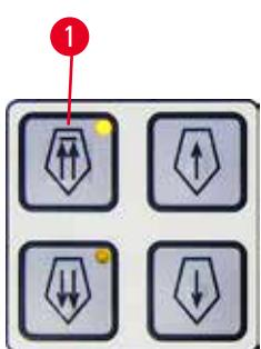
Электрическая система грубой подачи предназначена для быстрого перемещения образца в направлении к ножу или от него.
