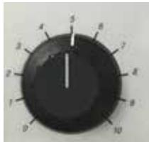
Скорость резания может задаваться непрерывно (в диапазоне 0–420 мм/с) с помощью вращающейся ручки. На ручке выбора скорости нанесена шкала с делениями от 1 до 10. Эта шкала дана в качестве ориентира и не отражает конкретную скорость.
