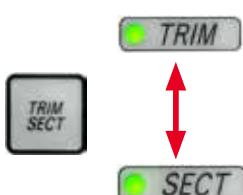
Для переключения между режимами надрезания и выполнения срезов нажмите кнопку **TRIM/SECT** на отдельной панели управления. При каждом нажатии кнопки индикатор переключается между **SECT** и **TRIM**.
