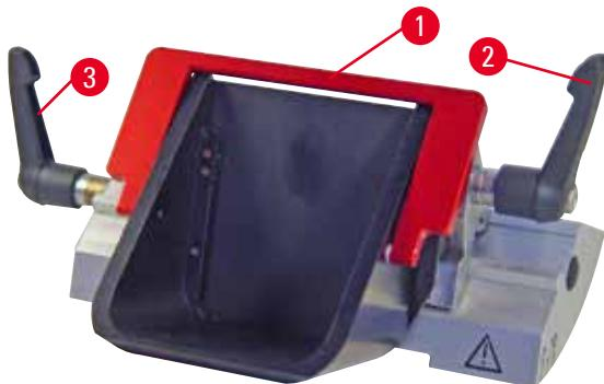
물통이 있는 나이프 홀더 E(→ "그림 77")는 로우 프로파일 블레이드에서만 사용됩니다. 나이프 홀더 E의 안전 가드는 적색 회전식 손잡이 (→ "그림 77-1") 형태입니다. 박절날을 덮으려면 안전 가드 손잡이(→ "그림 77-1")를 시계 방향으로 돌리십시오(그림 참조).
