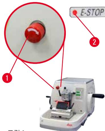
비상 정지 기능은 마이크로톰 전면의 왼쪽 위에 있는 적색 비상 정지 스위치(→ "그림 1-1")를 누르면 작동합니다. 비상 정지 스위치를 누르면 절편 모터가 즉시 멈춥니다. 기기 제어 패널의 E-STOP 필드(→ "그림 1-2")에서 적색 LED가 켜지면 비상 정지 기능이 작동되었다는 것을 나타냅니다.
