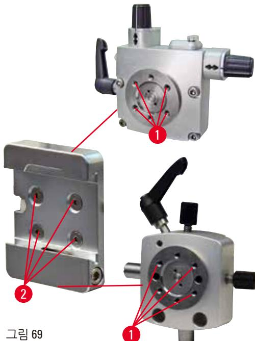
퀵클램핑 장치는 영점 표시기가 있는 시편 클램프용 미세 방향 조절형 고정 장치 또는 시편 클램프용 방향 조절형 고정 장치와 함께 사용하는 어댑터입니다. 2.5번 앤런 키를 이용해 스크류 4개(→ "그림 69-2")를 보어(→ "그림 69-1")에 넣어서 조이십시오.
