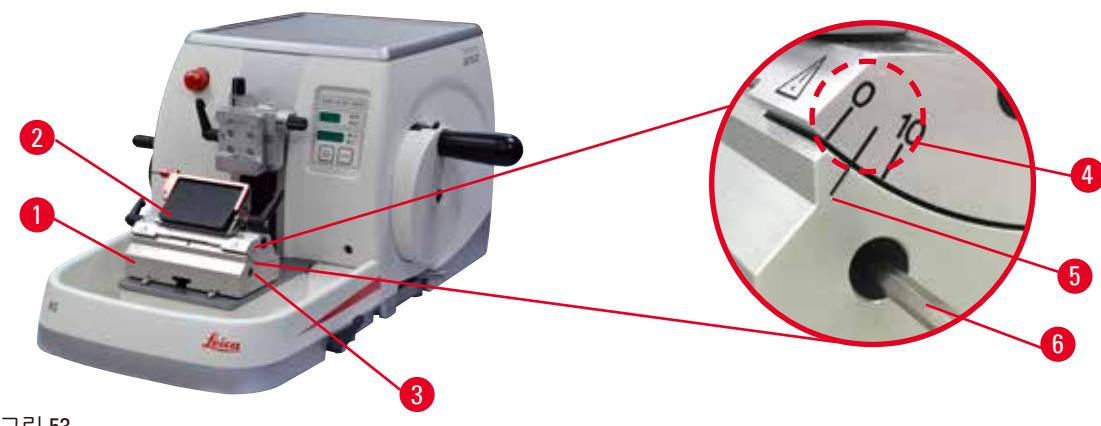
여유각의 조정을 위한 눈금( $0^\circ$ ,  $5^\circ$ ,  $10^\circ$ )(→ "그림 53-4")이 투인원 블레이드 홀더 E(→ "그림 53-2")의 우측면에 표시되어 있습니다. 블레이드 홀더 베이스(→ "그림 53-5")의 오른쪽에는 여유각 조정 시 참조할 수 있는 눈금(→ "그림 53-1")도 표시되어 있습니다.
