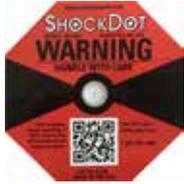
Sur l'indicateur Shockwatch, le point de choc signale par la couleur rouge les impacts ou les chocs supérieurs à une intensité donnée. En cas de dépassement d'une accélération définie (valeur g), le tube indicateur change de couleur.
