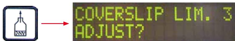
LIM (蓋玻片限值設定) 參數定義蓋玻片儲存器中剩餘蓋玻片數量，用於在顯示幕上顯示 COVERSHEETS LOW (蓋玻片不足) 通知。此訊息用於告知使用者儲存器中剩餘的蓋玻片臨界 (低) 數量。
