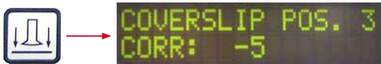
使用CSP (→「圖43-1」) (蓋玻片放置位置) 參數可以修改蓋玻片的放置位置 (→「圖43」)。
