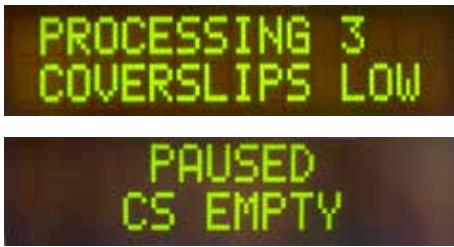
如果蓋玻片數量下降到限值以下，顯示幕上將顯示訊息**COVERSLIPS LOW**（蓋玻片不足）。
