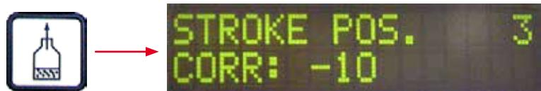
變更LEN（→「圖42-2」）（蓋玻片封固劑行程長度校正）可以縮短由STK（蓋玻片封固劑行程長度）參數所設定的蓋玻片封固劑行程長度。
