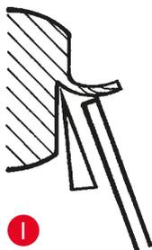
**Abb. I:** Der Schnitt rollt sich über den Glaseinsatz des Schnittstreckersystems.
