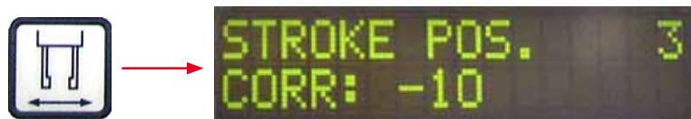
Начальное положение нанесения среды для заключения может изменяться при помощи параметра **STP** (→ Рис. 44-1) (Начальная точка нанесения среды для заключения).
