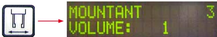
Регулируется время открытия клапана дозатора с шагом 1:
