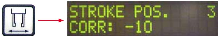
Položaj hoda medija za uklapanje pokrovног stakalca može se promijeniti pomoću parametra **STP** (→ Sl. 44-1) (početna točka hoda medija za uklapanje pokrovног stakalca) parametar.
