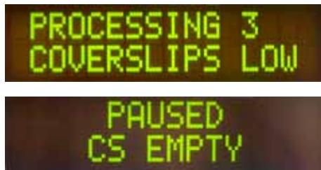
Ako broj pokrovnih stakalca padne ispod granične vrijednosti, na zaslonu se prikazuje poruka **COVERSLIPS LOW** (MALA KOLIČINA POKROVNIH STAKALCA).
