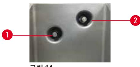
각 레토르트에는 유체 수위를 모니터링하기 위한 액체 수위 센서가 2개 있습니다. 아래쪽 센서(→ 그림 14-1)는 2개 바스켓 수위를 모니터링합니다. 위쪽 센서(→ 그림 14-2)는 레토르트에 최대량보다 많은 양의 액체가 유입되면 실행됩니다. 이 센서는 안전 기능을 담당합니다.
