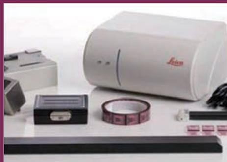
Il sistema opzionale di trasferimento con nastro CryoJane aiuta a produrre sezioni congelate sottili. Le sezioni sono prive di grinze, non compresse e intatte quando legate al vetrino del microscopio, fornendo una morfologia simile alle sezioni di paraffina. CryoJane è adatto per sezionare una grande varietà di tessuti, inclusi campioni difficili come tessuto adiposo mammario e osso non decalcificato.
