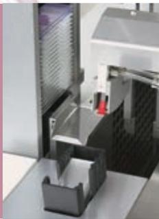
La stazione di parcheggio dell'erogatore alloggia l'ugello nel reagente, mantenendo così l'integrità del montante dispensato.
