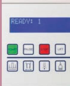
La station de montage de lamelles accepte différents formats de lamelles couvre-objet et se débarrasse automatiquement de celles qui sont cassées.
