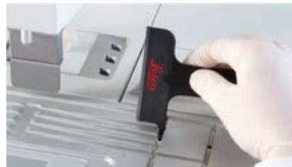
Una superficie metallica di lavoro **facile da pulire** offre minore aderenza. La struttura **resistente** dello speciale raschietto aiuta a pulire le fessure dalla paraffina.
