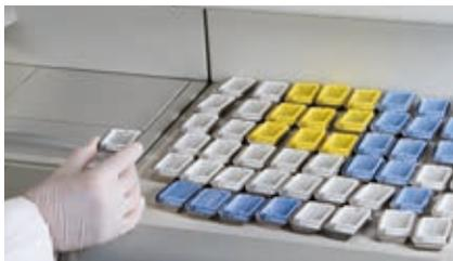
La piastra fredda contiene fino a 65 cassette su un'ampia superficie di lavoro. L'efficienza del raffreddamento è importante. È per questo che la piastra di raffreddamento è dotata di un **modulo di controllo adattivo** che garantisce una temperatura di lavoro **stabilizzata a -6 °C** per adattarsi ai normali ambienti di laboratorio.
