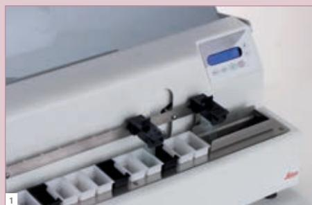
1 Tanque de coleta para 16 lâminas
