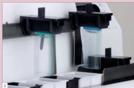
2 Racks de quatro lâminas, quatro lâminas por transportador/rack de lâminas
