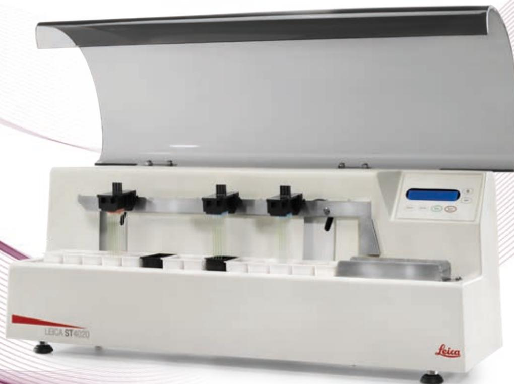
1 Coloratore lineare Leica ST4020 dotato di calotta opzionale
