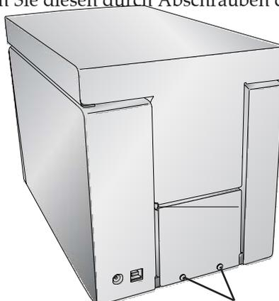
**Schrauben der hinteren Zugangsöffnung**
