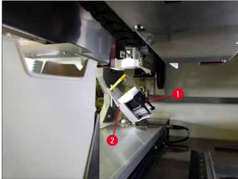
**Fig. 122****8.3.6 Remoção do rack da pinça acima do rotador**
