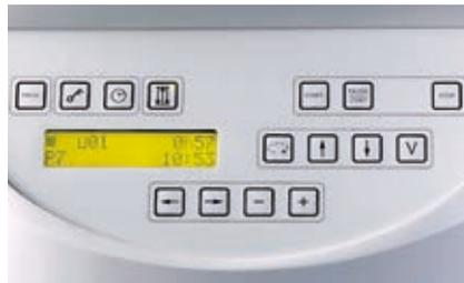
Les boutons du panneau de commande sont disposés en groupes fonctionnels. Facile à lire, l'écran LCD indique les paramètres de la station, tels que le nombre de paniers traités, la fonction de vide et le temps d'infiltration restant, le temps réel, l'heure de début (démarrage différé), la durée globale et l'heure de fin d'exécution. Chacun des neuf programmes peut être exécuté avec un démarrage immédiat ou différé.
