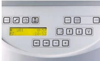
I pulsanti sono disposti in gruppi sul pannello di controllo a seconda della funzione. Il display LCD di facile lettura mostra i parametri della stazione, come il numero di cestelli per preparati, la funzione del vuoto così come il tempo di infiltrazione rimanente, l'orario reale, l'orario di avvio (avvio ritardato), la durata complessiva e l'orario do termine del ciclo. Ciascuno dei nove programmi può essere eseguito con avvio immediato o ritardato.
