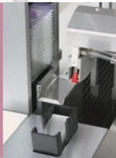
ディスペンサーのパーキングステーションは、ノズルを試薬に収納し、封入剤の分注の完全性を維持します。
