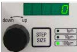
Dreieknapp 2, som brukes til å bevege prøveholderen vertikalt, kan brukes til å finjustere avstanden mellom bladet og prøven samt til å stille inn ønsket snittykkelse. Trinnstørrelse: 1, 10 eller 100  $\mu\text{m}$  kan velges med **STEP SIZE**-knappen.
