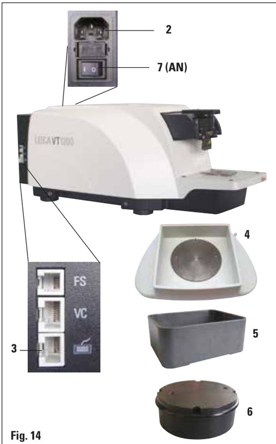
1. Sett strømbryteren (7) på høyre side av apparatet på OFF (O).
