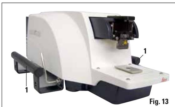
Una volta che lo strumento si trova nel suo luogo d'installazione definitivo, le impugnature di trasporto (1) vanno rimosse dallo strumento svitandole con la chiave maschio esagonale da 6 acclusa e conservate insieme alle viti che le fissavano.
