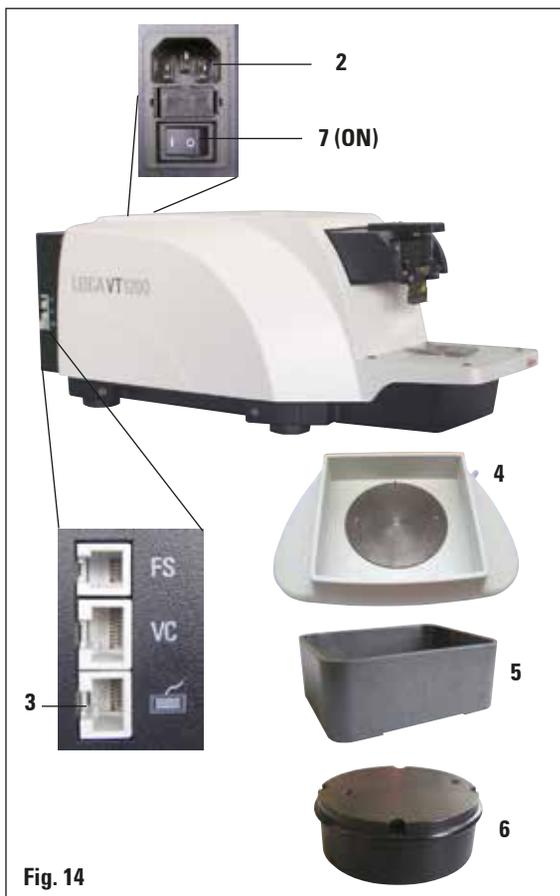
1. Impostare su OFF (○) l'interruttore di rete (7) laterale sulla destra dello strumento.
