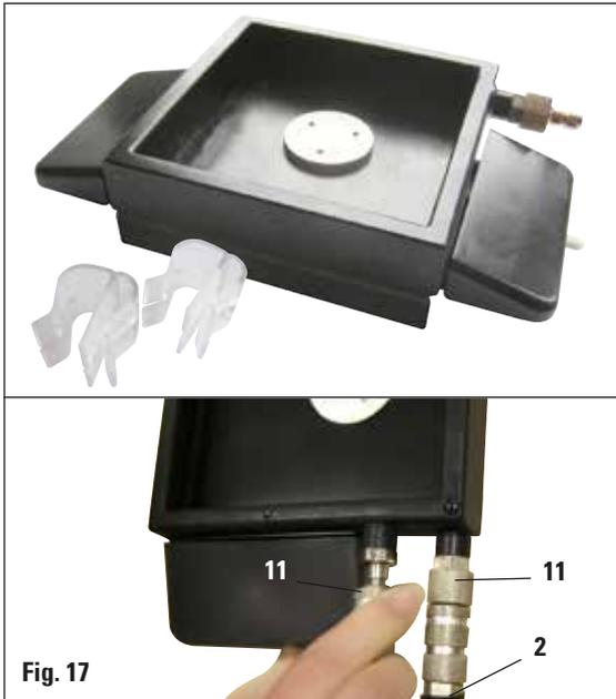
La vasca tampone a doppia parete può essere munita di molle che hanno lo scopo di tenere in posizione corretta un tubo flessibile per l'alimentazione con gas del buffer.
