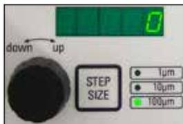
La manopola 2 per il movimento verticale del supporto del campione può essere usata sia per l'avanzamento di precisione del campione alla lama, sia per la regolazione degli spessori di taglio desiderati. Il passo di taglio: 1, 10 o 100  $\mu\text{m}$  può essere scelto premendo il tasto **STEP SIZE**.
