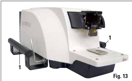
Quand l'appareil est en place à son emplacement définitif : dévisser les poignées de transport (1) en utilisant la clé pour vis à six pans creux d'ouverture 6 (fournie) puis ranger les poignées et les vis en lieu sûr.
