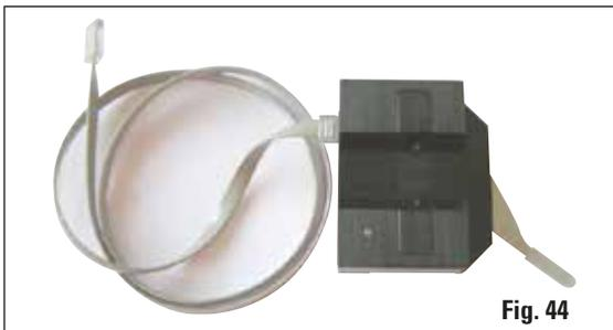
Dispositif de mesure optionnel, pour l'affichage de la déviation verticale de la lame (en  $\mu\text{m}$ ) et l'affichage du sens de rotation des vis afin de minimiser la déviation verticale de la lame. Ajustable par une vis de réglage sur le porte-lame.
