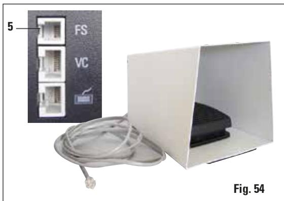
Conectar el interruptor de pedal al conector superior "FS" (5) situado en el lateral izquierdo del equipo básico.
