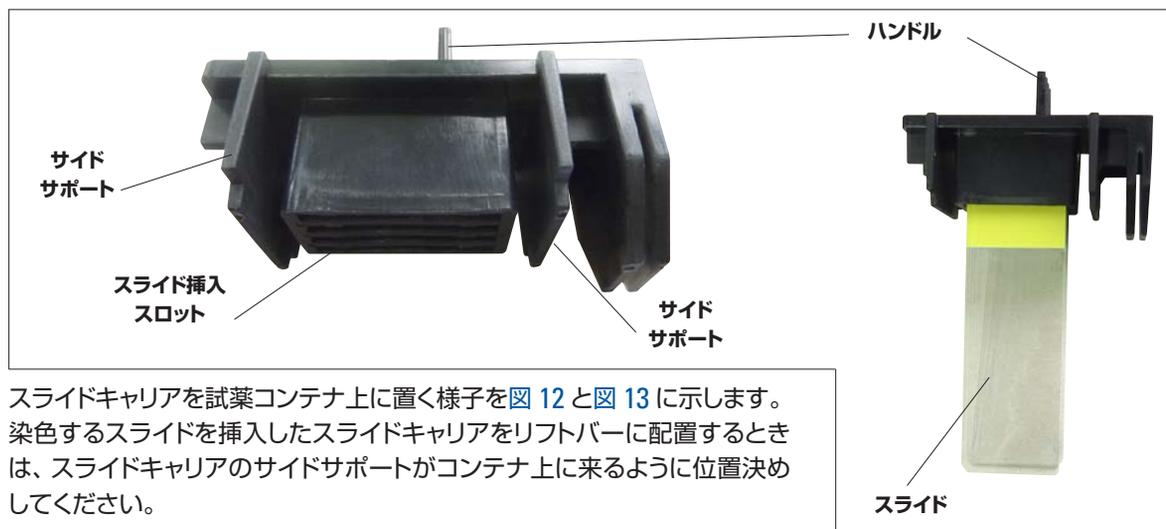
スライドキャリアを試薬コンテナ上に置く様子を図 12 と図 13 に示します。染色するスライドを挿入したスライドキャリアをリフトバーに配置するとき、スライドキャリアのサイドサポートがコンテナ上に来るように位置決めしてください。
