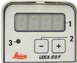
il pannello di comando sul lato anteriore dell'unità di controllo è composto da una tastiera a membrana (2), da un display a una riga (1) e da un LED (3) che lampeggia nella fase di riscaldamento. Una volta che la temperatura di esercizio prescelta è stata raggiunta, la spia rimane accesa e segnala che lo strumento è operativo.
