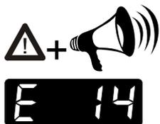
Diese Übertemperatur-Schutzeinrichtung ist fest auf 85 °C eingestellt und wirkt unabhängig vom Regelkreis. Bei ihrem Ansprechen werden Kompressor und Umwälzpumpe allpolig, bleibend abgeschaltet. Die Alarmanzeige erfolgt optisch und akustisch mit anhaltendem Signalton und am LED-DISPLAY erscheint die Fehlermeldung "Error 14".
