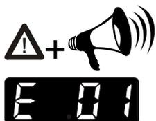
Diese Schutzeinrichtung wirkt unabhängig vom Regelkreis. Beim Ansprechen der Unterniveau-Schutzeinrichtung werden Kompressor und Umwälzpumpe allpolig, bleibend abgeschaltet
