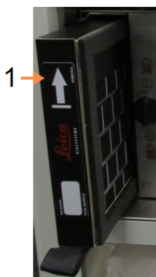
Фигура 7-12: Смяна на карбоновия филтър със стрелка (1) нагоре
