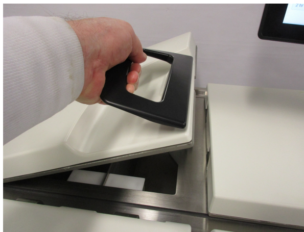
Фигура 2-13: Отваряне на капак на восъчна баня
