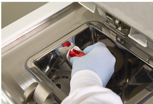
Фигура 7-4: Използване на инструмента за почистване на LLS
