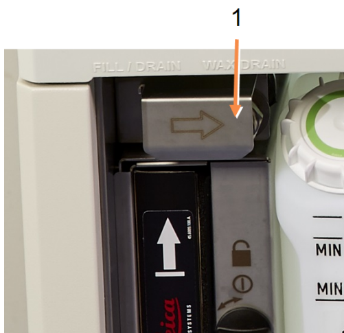
Фигура 5-11: Капакът за отдалечено пълнене/дрениране се отваря с линията на реагента (ляво) и линията за восъчен отпадък (дясно)
