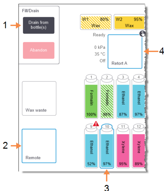
Фигура 5-13: Настройка за отдалечено пълнене/дрениране за дрениране на бутилки
