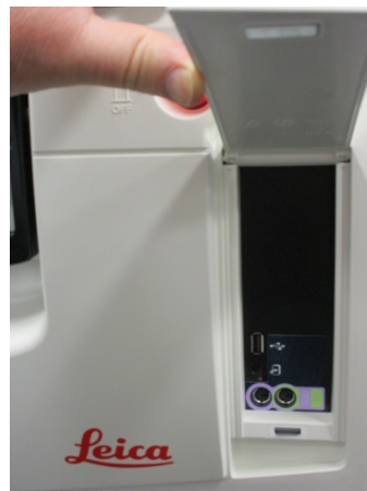
Фигура 2-17: Преден USB порт, зад капака
