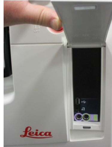
圖 2.17: 封蓋後面的前方 USB 連接埠
