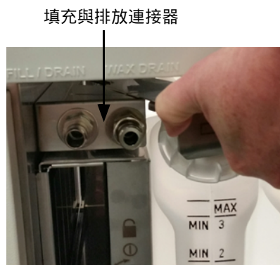
圖 5.11: 遙距填充 / 排放封蓋開啟，附帶試劑管線（左）與蠟廢棄物管線（右）。
