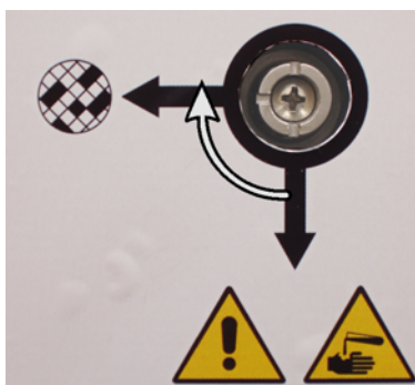
圖 2.20：內部過濾器中的蒸氣單向閥
