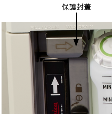
圖 5.10: 遙距填充 / 排放封蓋關閉
