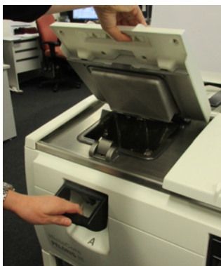
圖 2.3: 開啟蒸餾瓶蓋子
