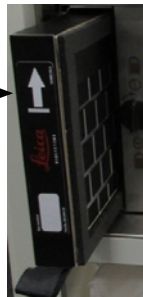
圖 7.12: 更換碳過濾器，方向箭咀 (1) 朝上
