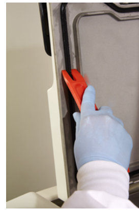
Şekil 7.3: Parafin kazıyıcının kullanılması
