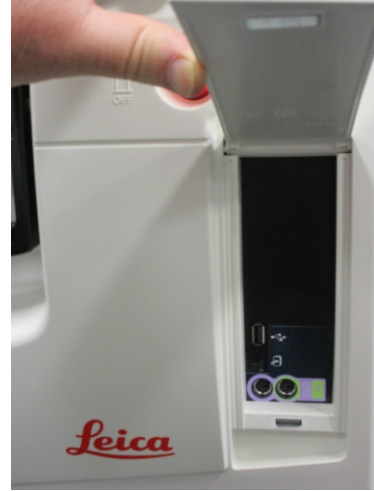
Şekil 2.17: Kanadın arkasındaki ön USB bağlantı noktası
