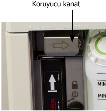
Şekil 5.10: Uzaktan dolum/tahliye kanadı kapalı
