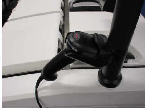
Şekil 2.15: Tutucunun içerisindeki barkod tarayıcısı
