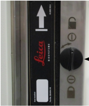
Şekil 7.10: Filtre kilidinin açılması
