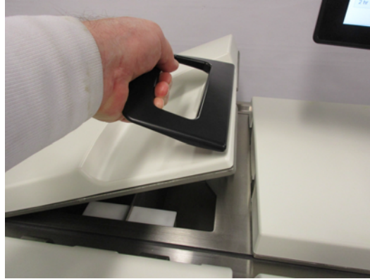
Şekil 2.13: Parafin banyosunun kapağının açılması
