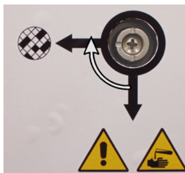
Figur 2.20: Ångstyrningsventilen inställd på det interna filtret
