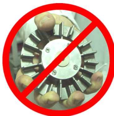
Figur 7.9: Hantering av omröraren – korrekt (vänster) och felaktig (höger)
